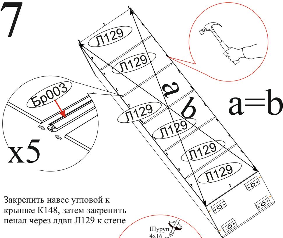
Закрепить навес угловой к крышке К148, затем закрепить пенал через лдвп Л129 к стене
