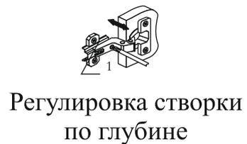
Регулировка створки по глубине
